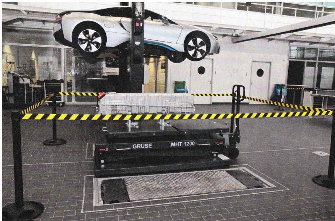
Obrázek 38: Stání vozidla v servise s demontovanou VN baterií
