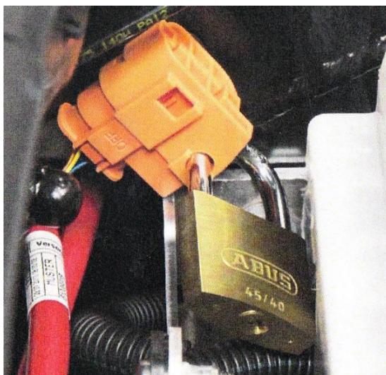
Obrázek 37: Zajištěný konektor vysokého napětí
