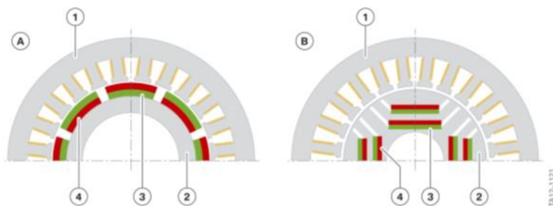
A-konvenční motor, B-motor BMW, 1-stator, 2-rotor, 3-jihní pól permanentního magnetu, 4-severní pól permanentního magnetu
