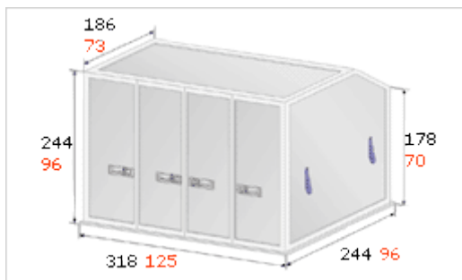
Typ AMJ Rozměry 318 x 244 x 244 cm Vnitřní objem 17 m 3 Nosnost 6469 kg Vhodný pro letadla B747, MD11
