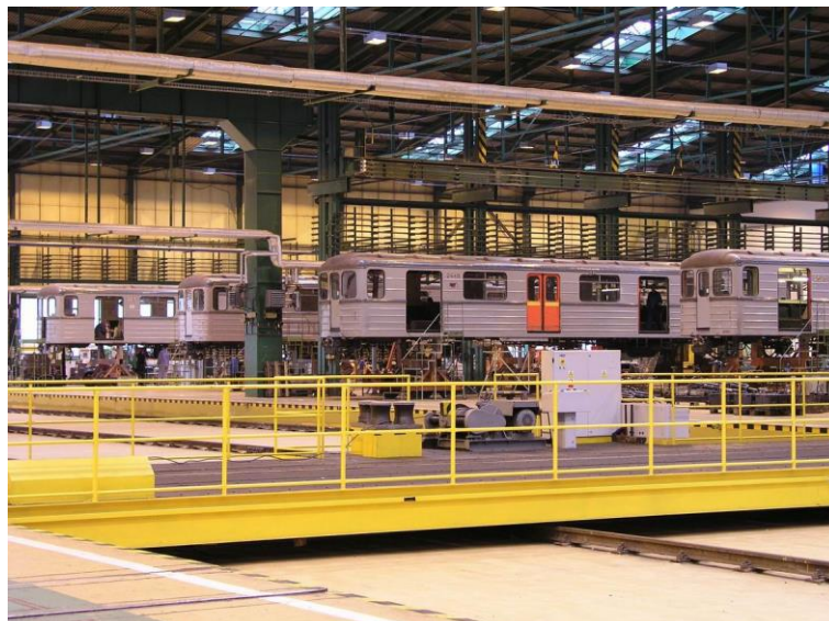
Obrázek 5: Vozy souprav metra: 81–71 čekající na výměnu podvozků 5
