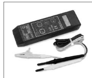
Obr. 13. Měřič impedance smyčky SONEL MZC - 200
