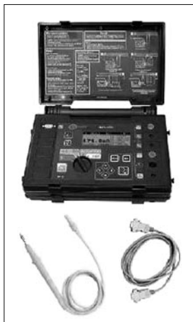
Obr. 14. Měřič impedance smyčky čtyřvodičovou metodou SONEL MIC - 310S
