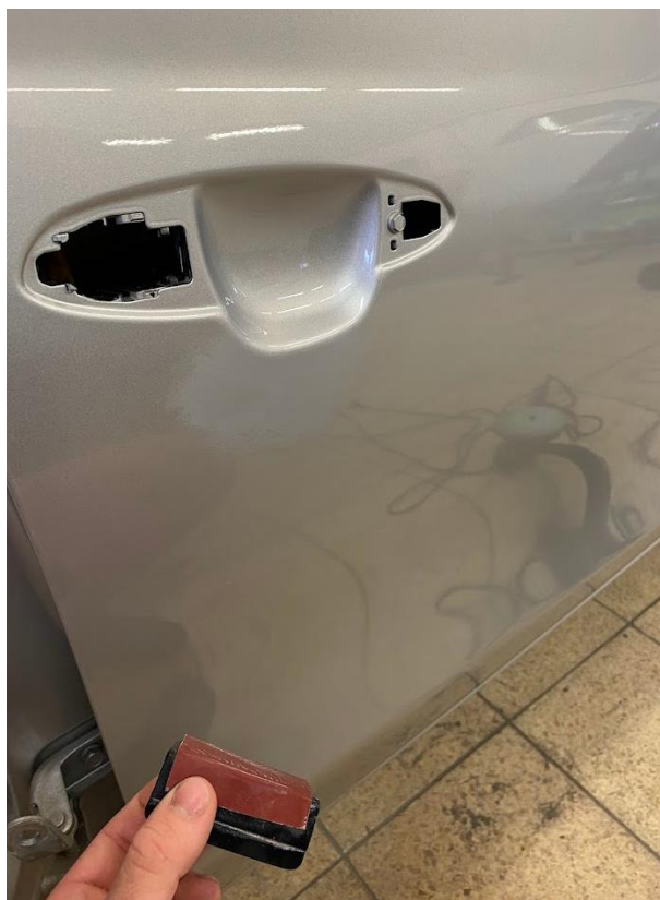
Obrázek 6: Rozlešťování lakovaného dílu
