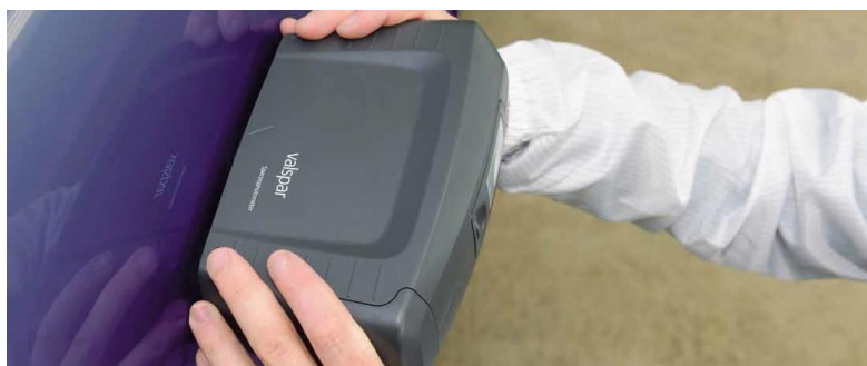
Obrázek 5: Načtení barvy dílu spektrometrem (ilustrační obrázek)
