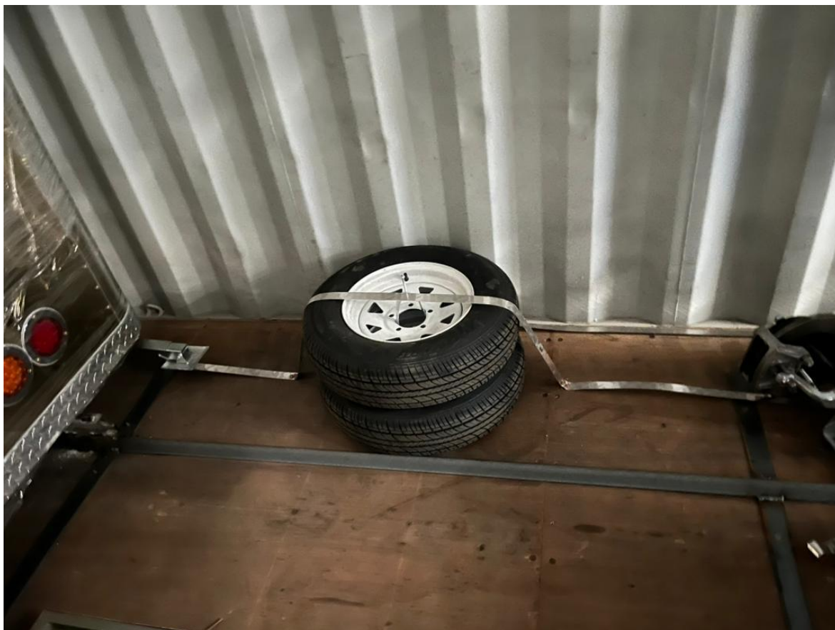
Příloha 9: Připevnění odmontovaných kol k podlaze kontejneru
