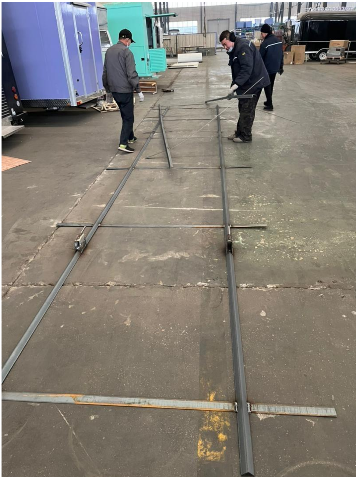
Příloha 4: Kolejnicová konstrukce pro nakládku food traileru
