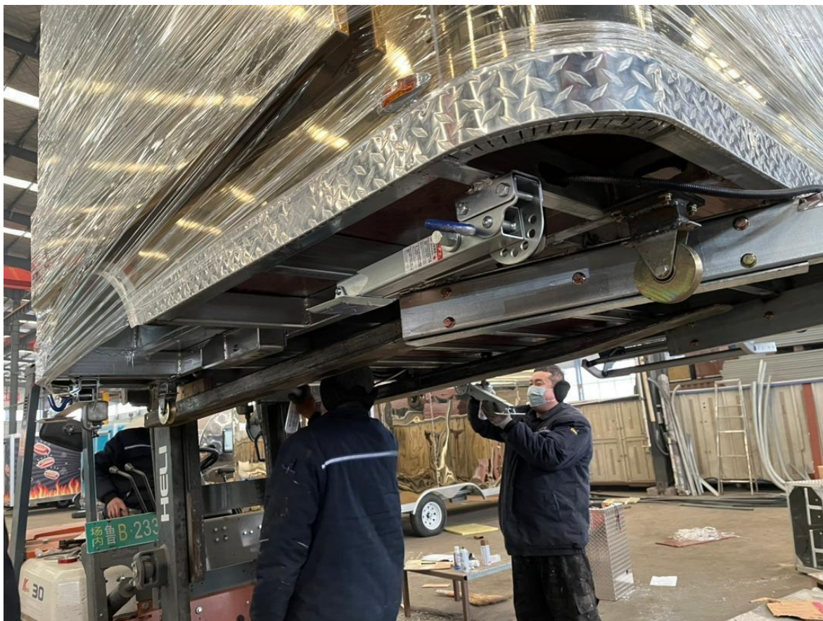
Příloha 5: Přivařená kolečka pro posun na kolejnicích
