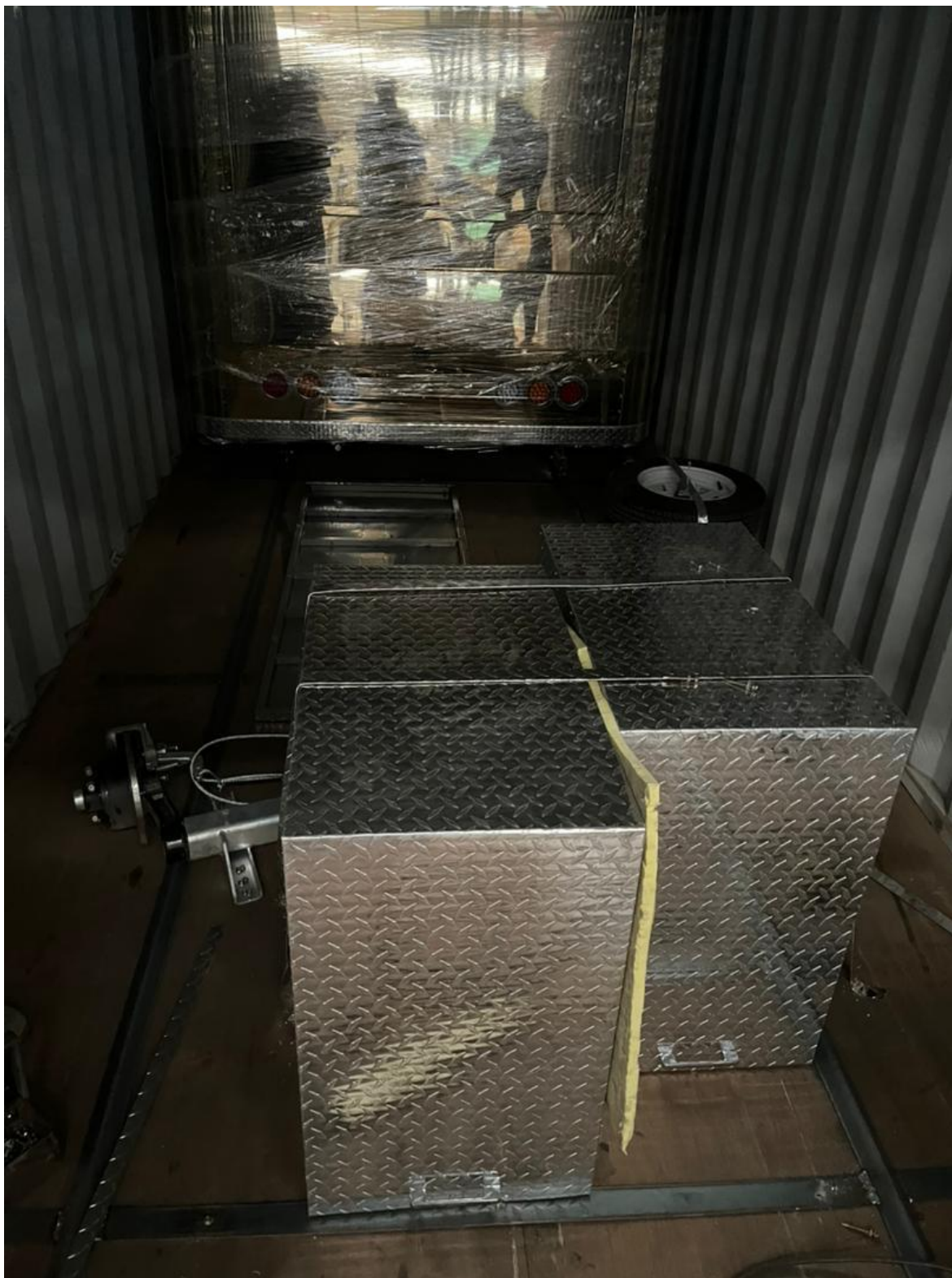
Příloha 11: připevnění chladících boxů k podlaze kontejneru
