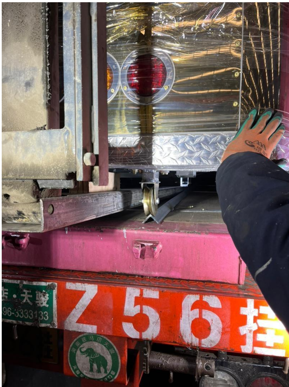
Příloha 8: Posun food traileru po kolejnicové konstrukci
