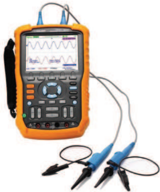
Obr. 5 Digitální osciloskop Siglent SHS 1000
