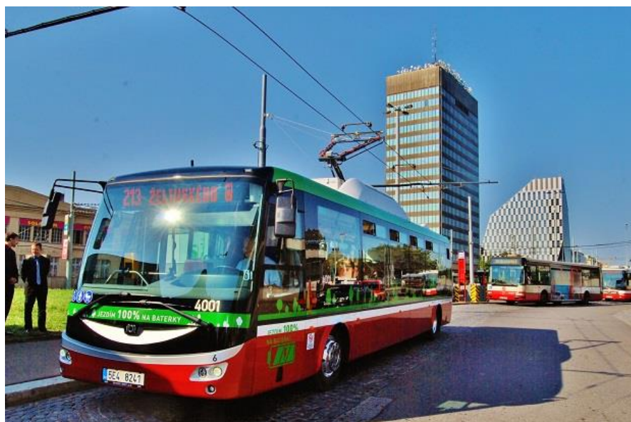
Obr. 11: Elektrobusem SOR EBN 11, který se zrovna nabíjí v obratišti Želivského
