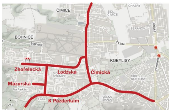
Obr. 24: Vhodné úseky k „zatrolejování“ v Bohnicích a Čimicích
